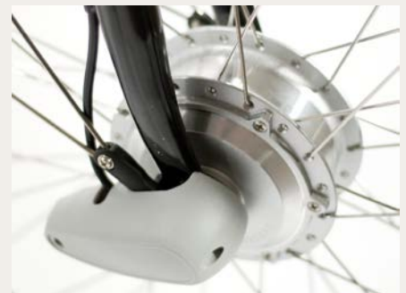
Nejprodávanější pohon pro elektrokola kategorie Pedelec 25 v roce 2011 v Evropě – motor s převodovkou do náboje firmy 8Fun z Číny.
