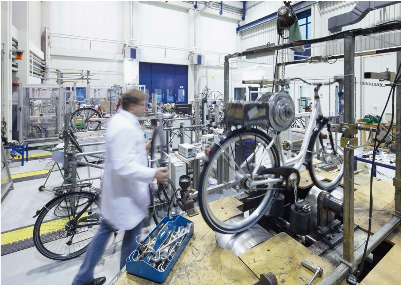
Zkušební stav pro elektrokola v TÜV Rheinland
