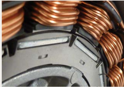
Elektromagnet a permanentní magnet, osvědčený princip nachází uplatnění ve většině motorů pro LEV.
