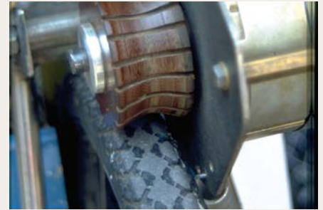
Pohon třecími válečky u solárního kola ruského průkopníka solárních kol Alexandra Popolova 1989.
